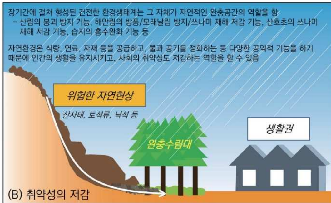
그림 3. Eco-DRR에 있어 노출의 회피(A)와 취약성 저감(B)의 예시
