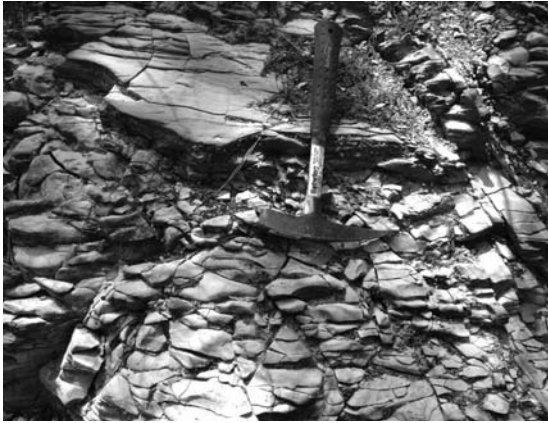
그림 5. 과거 사방녹화사업을 실시한 포항·영일지역에서 이암층이 풍화되어 집중호우시 상부토층을 밀고 내려오는 붕적층 땅밀림이 우려되는 사례
