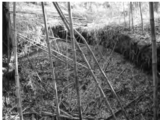
그림 2. 땅밀림 산사태지에 발생하는 인장균열에 의한 단차 발생지 및 인장균열
