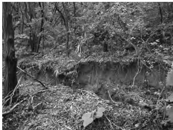
그림 2. 땅밀림 산사태지에 발생하는 인장균열에 의한 단차 발생지 및 인장균열
