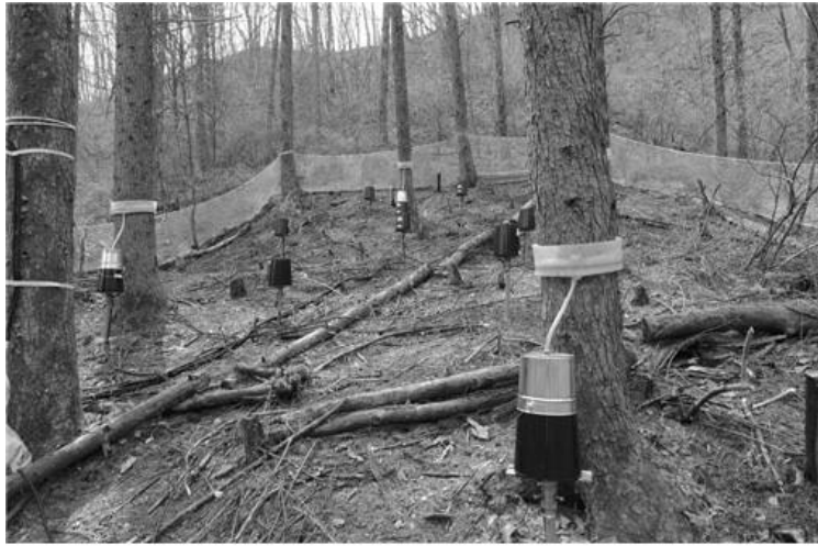
그림 4. 수관차단 손실량 측정 장치
