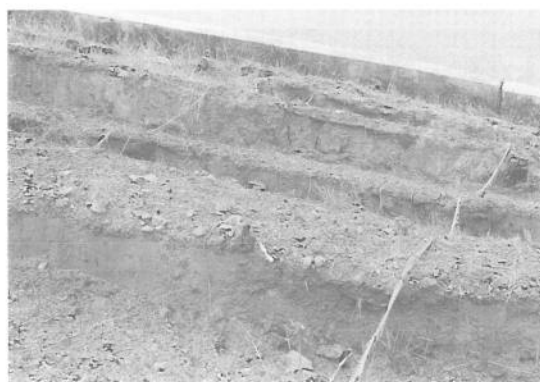
강원 삼척 근덕 초곡리 변성작용을 받은 우백질 화강암으로 땅밀림현상에 의하여 전도파괴 현상을 보이고 있다.
