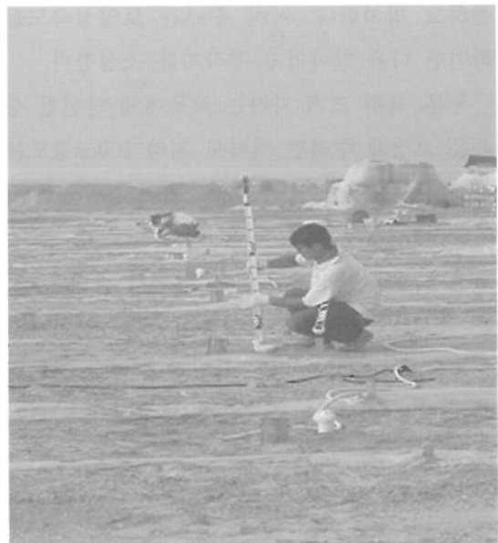
그림 6. 각 구분 처리구에 대해 토심별 토양 수분 측정기(FDR)를 설치하고 있다.
