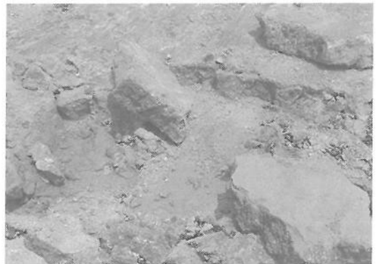
그림 3. 무지개떡처럼 경계가 선명한 복토지. 물리적으로는 절대로 하나가 되지 않지만 화학적으로는 하나가 되려는 작용이 지속되어 점차 매립토양의 염분을 함유하게 된다.
