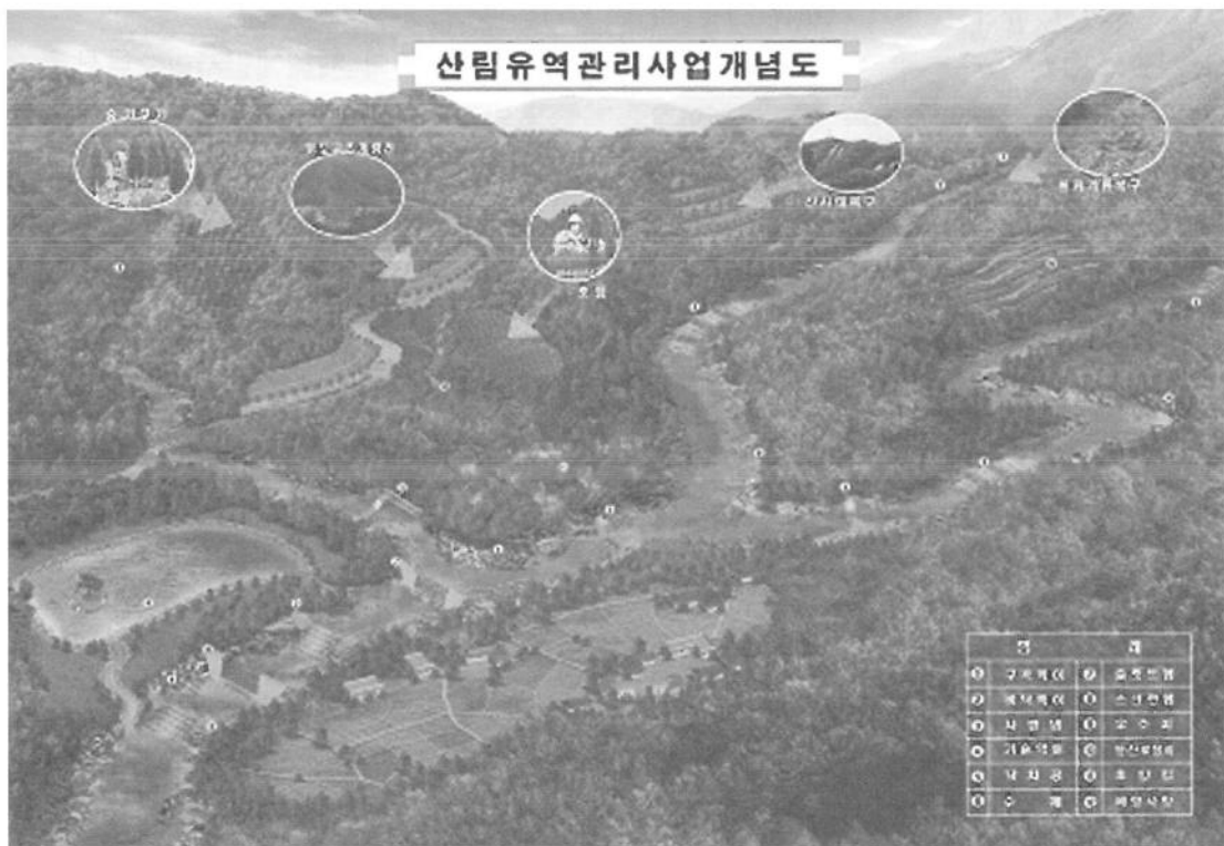
그림 1. 산림유역관리사업은 붕괴위험사면 및 복구지 등에 대한 예방·복구사방, 다양한 구조물에 의한 야계사방, 임도 구조개량, 숲 가꾸기 등 산림사업으로 재해에 튼튼한 유역을 만드는 종합적인 재해예방사업이다.
