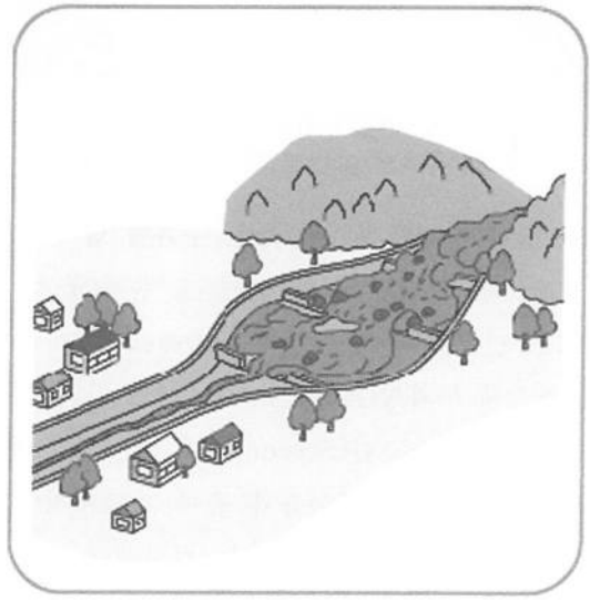
그림 3. 유사지 설치로 상류에서 유입된 다량의 토사를 일시적으로 저류함. 넓은 유로에 분산시키는 한편 토사유출 속도를 늦추고 유출시간을 분산시켜 하류로 흘러보냄.
